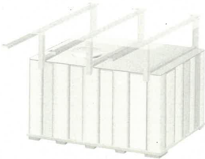
Abbildung 10: Auftriebsicherung, Bsp. standortgefertigter Stahltank
